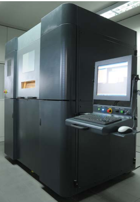
Για την ανάπτυξη νέων εξαρτημάτων υπάρχει μηχανή ταχείας πρωτοτυποποίησης με τη μέθοδο laser sintering. For the development of new products a Rapid prototyping machine is used (laser sintering).
