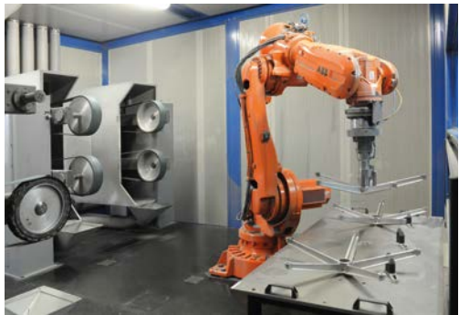
Γυάλισμα με χρήση ρομπότ Polishing with the use of robotics
