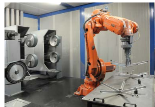
Τρόχισμα - Γυάλισμα με χρήση ρομπότ Sharpening - Polishing with the use of robotics
