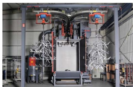
Κατεργασία με ατσαλοβολή Surface processing with shot blasting
