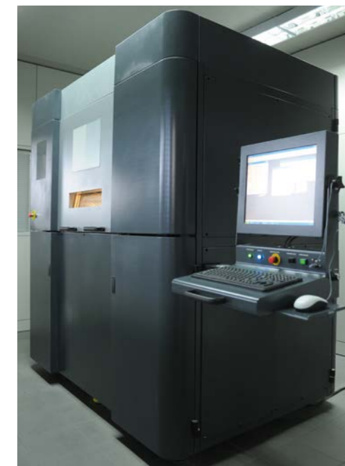
Για την ανάπτυξη νέων εξαρτημάτων υπάρχει μηχανή ταχείας πρωτοτυποποίησης με τη μέθοδο laser sintering. For the development of new products a Rapid prototyping machine is used (laser sintering).
