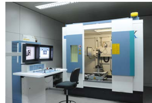
Εσωτερικός έλεγχος δομής αλουμινίου με X-Ray Internal control machine of aluminium structure with X-rays
