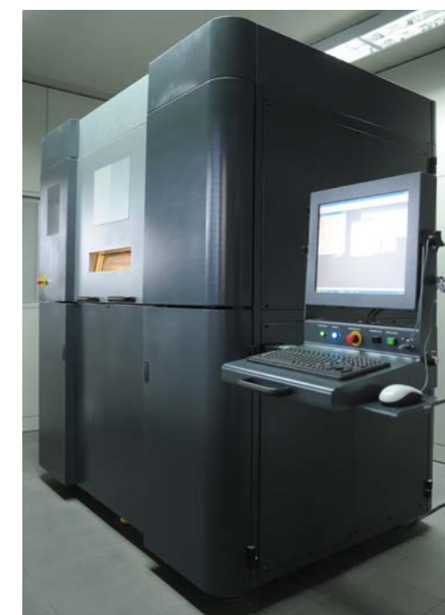
Για την ανάπτυξη νέων εξαρτημάτων υπάρχει μηχανή ταχείας πρωτοτυποποίησης με τη μέθοδο laser sintering.
