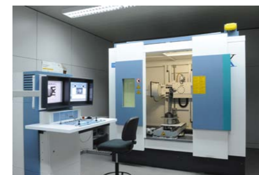
Εσωτερικός έλεγχος δομής αλουμινίου με ακτίνες Χ
